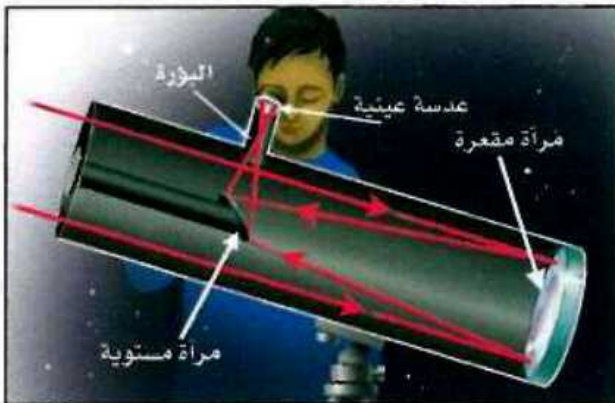
ب- في المنظار الفلكي العاكس تقوم مرآة مقعرة بتجميع الضوء لتكوين صورة تقع بين البؤرة الأصلية والمركز البصري للعدسة العينية.
