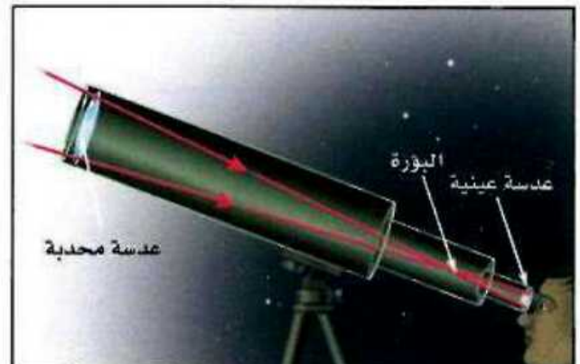
أ- في المنظار الفلكي الكاسر، تقوم العدسة المحدبة الشيئية بتجميع الضوء لتكوين صورة بين البؤرة والمركز البصري للعدسة العينية.
