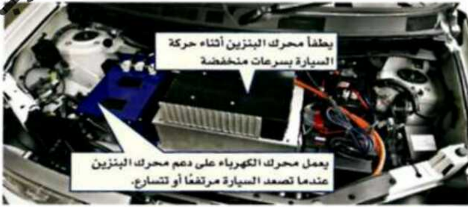
الشكل ٧ السيارات المعتمدة على البنزين / الكهرباء - كالتى في الشكل - تقلل من استخدام البنزين فهي تحتوي على محركين: أحدهما يعمل بالبنزين، والآخر بالكهرباء.
