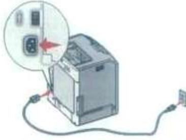
شكل (٢-٢-٢): توصيل الطابعة بمصدر التيار الكهربائي
