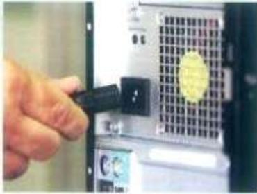
شكل (١-١-٢): فصل التيار الكهربائي عن جهاز الحاسب الشخصي
