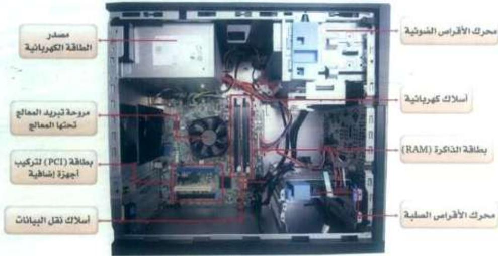
شكل (٥-١-٢): المكونات الداخلية لجهاز الحاسب
