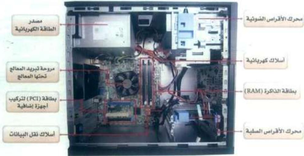
شكل (٥-١-٢): المكونات الداخلية لجهاز الحاسب
