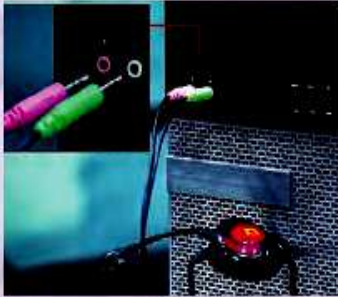
شكل (٤-١): توصيل سماعة الرأس بالحاسب
