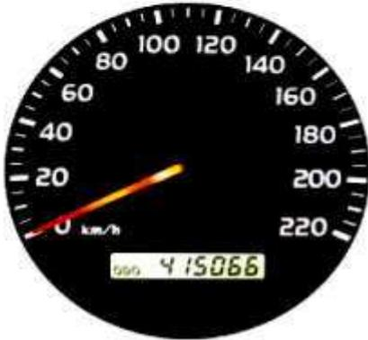
**الشكل ٢** يقيس عداد المسافة في السيارة المسافة التي قطعتها، بينما يعطي مقياس السرعة السرعة اللحظية. صف كيف تستعمل عداد المسافة لحساب السرعة المتوسطة؟
