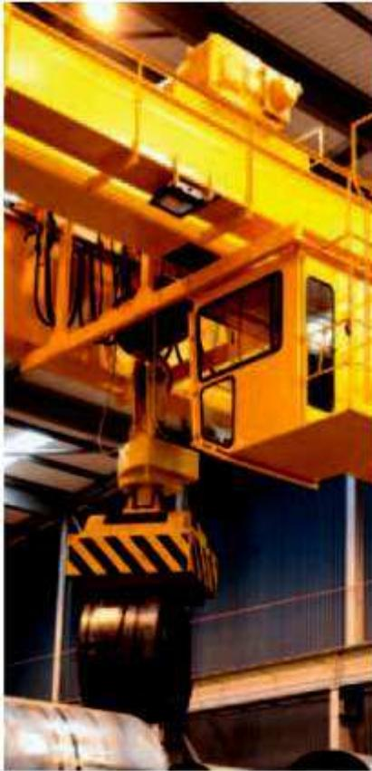
**الشكل ٨** يستخدم المغناطيس لرفع الأجسام الفلزية التي لها قابلية الانجذاب للمغناطيس.
