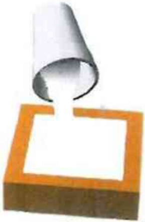
الشكل (٨): صب الجص في إطار خشبي.
