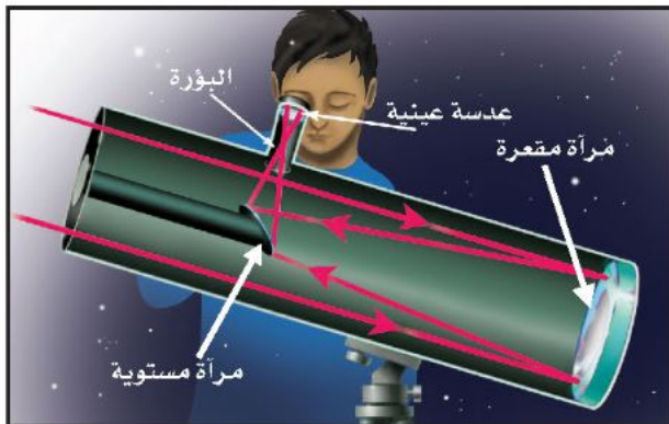
ب- في المنظار الفلكي العاكس تقوم مرآة مقعرة بتجميع الضوء لتكوين صورة تقع بين البؤرة الأصلية والمركز البصري للعدسة العينية.
