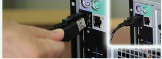
شكل (٦-١-٢): توصيل سلك الفأرة بالمنفذ المناسب له في صندوق الحاسب
