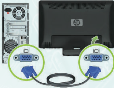
شكل (٢-١-٨): توصيل سلك الشاشة بالمنفذ المناسب له خلف صندوق الحاسب
