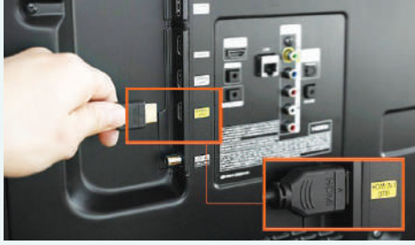
شكل (٩-٢-٢): توصيل أحد طرفي سلك (HDMI) إلى منفذ (HDMI) على التلفاز
