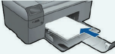
شكل (٤-٢-٢): تعبئة الطابعة بأوراق الطباعة
