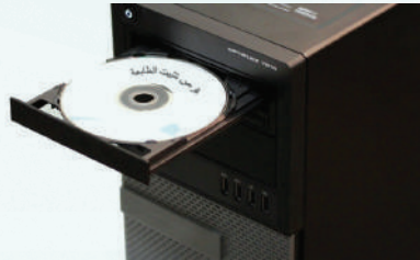
شكل (٥-٢-٢): ادخال القرص الضوئي الخاص بتثبيت الطابعة
