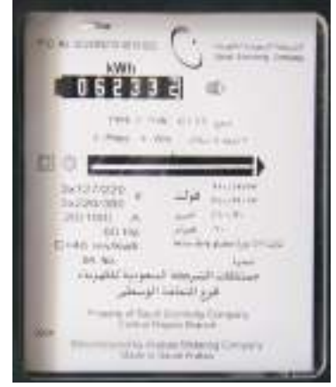
الشكل ١٤ عداد كهرباء يقيس كمية الطاقة الكهربائية المستهلكة بوحدة كيلوواط. ساعة. تعرف عداد الكهرباء المركب في منزلك.
