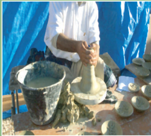
الشكل (١٦): صور توضح كيفية صنع الآنية ودورق الماء من الطين.
