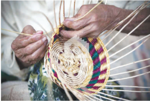
الشكل (٥٨): نسج سعف النخيل يدوياً لإنتاج السلال.
