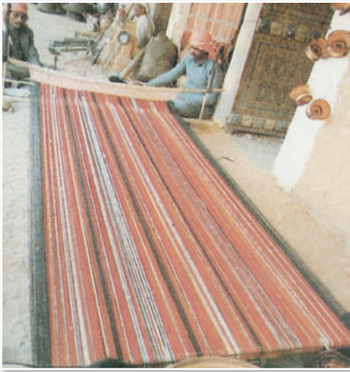
الشكل (٦٥): نول أرضي لإنتاج قطعة كبيرة.
