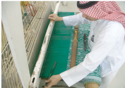
الشكل (٦٢): نلاحظ كيف يمرر النسيج المكوك.
