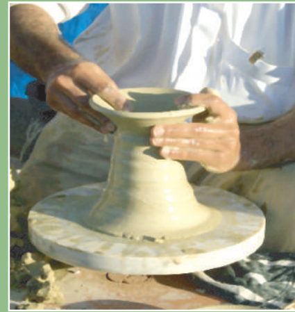
الشكل (١٦): صور توضح كيفية صنع الآنية ودورق الماء من الطين.
