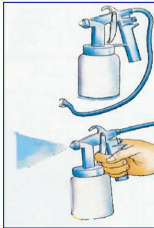
الشكل (٣٥): بخاخة موصلة بمضخة.
