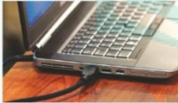
شكل (٢-٢-١٠): توصيل أحد طرفي سلك (HDMI) إلى منفذ (HDMI) على جهاز الحاسب
