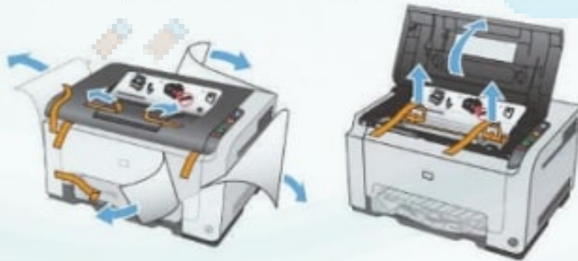
الشكل (١-٢-٢): إزالة جميع أشرطة التغليف من الطابعة وعبوات الأحبار
