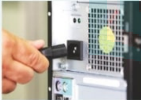
شكل (١-٢): فصل التيار الكهربائي عن جهاز الحاسب الشخصي
