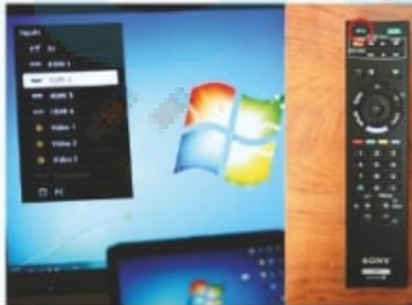
شكل (٢-٢-١١): ضبط إعدادات العرض في جهاز التلفاز من خلال جهاز التحكم عن بعد
