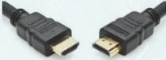
شكل (٢-٢-٨): سلك (HDMI) للتوصيل بين جهاز الحاسب والتلفاز
