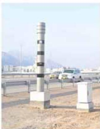
تعمل أجهزة ضبط السرعة على الكشف عن أي سيارات تسير بسرعة أكبر من السرعة المسموح بها، وتلتقط صورة لها.
