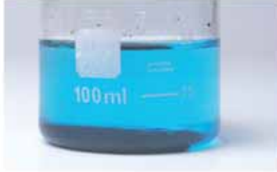
يتفاعل أكسيد النحاس مع حمض الكبريتيك.
