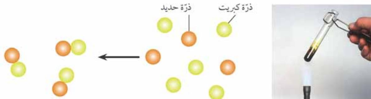
عند تسخين الحديد والكبريت، ترتبط ذرات الحديد وذرات الكبريت معًا لتكوين مركب كبريتيد الحديد.
