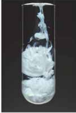
عند تفاعل نترات الفضة وكلوريد الكالسيوم ينتج راسب.
