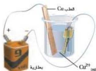
(61) الطلاء بالكهرباء يوضح الشكل 5-27 مفتاحاً يطل على كهربائياً بالنحاس في خلية تحليل كهربائي . فلين تحدث الأكسدة ؟ فسر إجابتك .
